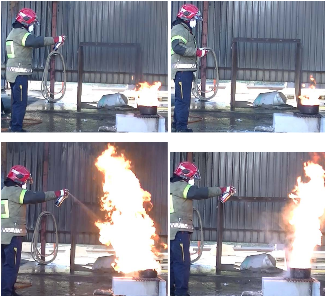
Figur B-4 Flammehøyden økte med en faktor på 4-5 da Elotec Elostop (venstre) og BRANNSTOP (høyre) ble brukt mot en friturebrann. Ingen av de klarte å slokke brannen. Den økte flammehøyden skyldes trolig at slökkemiddelet består av mye vann som fordampes idet det kommer i kontakt med den varme oljen. Når vandampen forsvinner fra gryta tar det med seg små oljedråper som brenner i luften.
