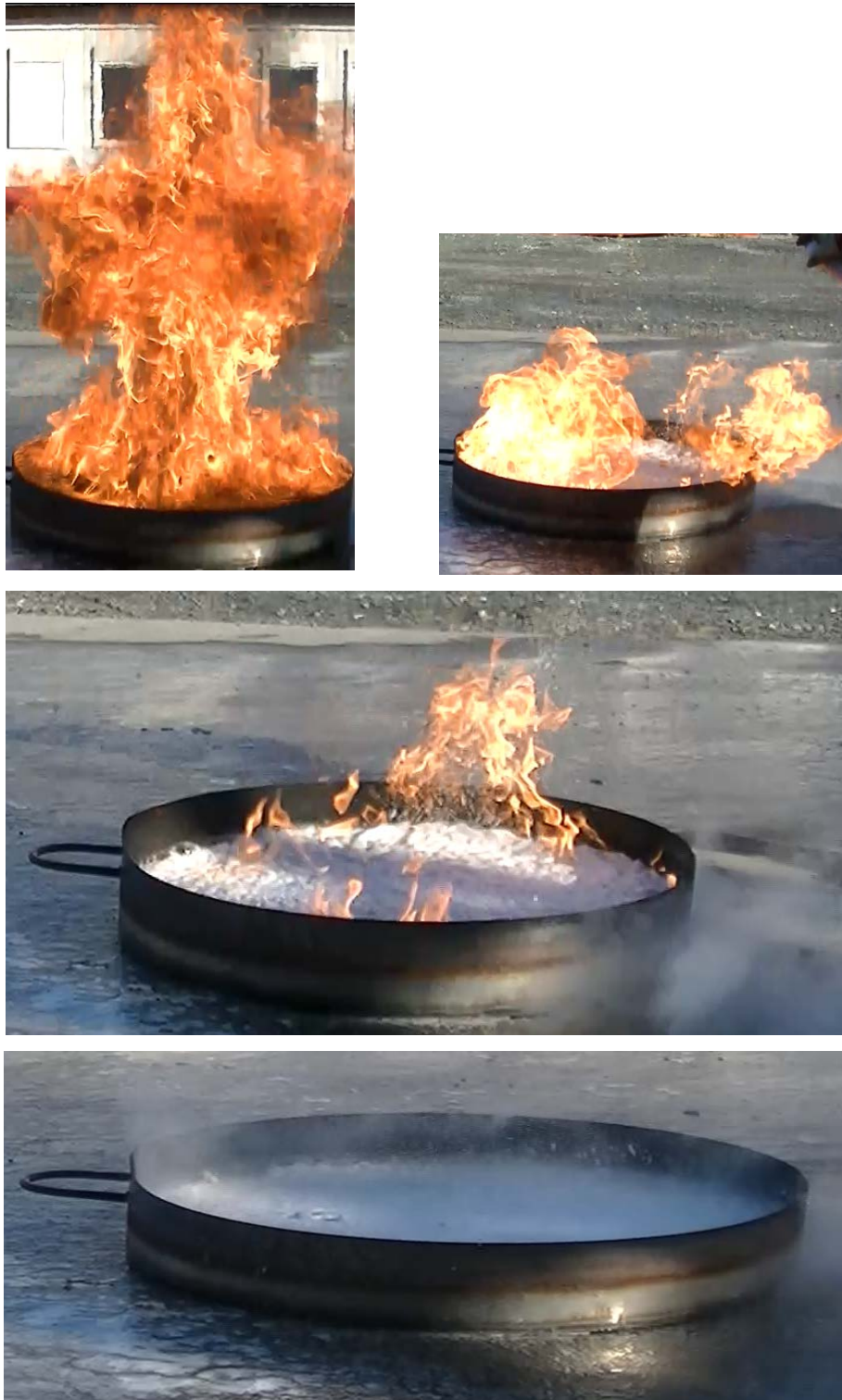
Figur B-3 Brannscenario 21B består av et sirkulært kar med diameter 92 cm. Flere produkter dempet brannen kraftig, men FIRESTOP var det eneste produktet som klarte å slokke brannen i denne testen (2 av 4 forsøk), som vist i bildene over. Bildene er tatt før start (øverst til venstre), etter 9 sekunder (øverst til høyre), etter 12 sekunder (nest nederst) og etter 24 sekunder (nederst).
